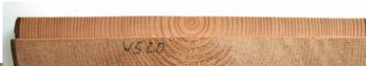
Prélèvement de barreaux sur rondelles
