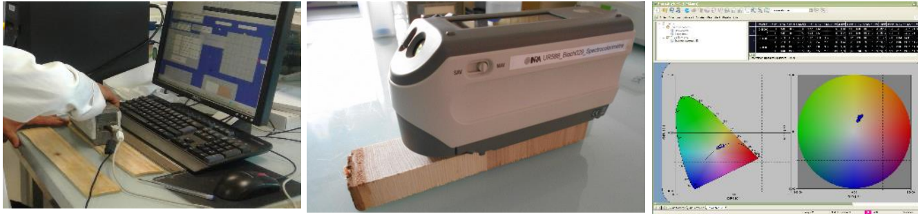
Spectrocolorimètre Konica-Minolta modèle CM 2600d (360-740 nm)
