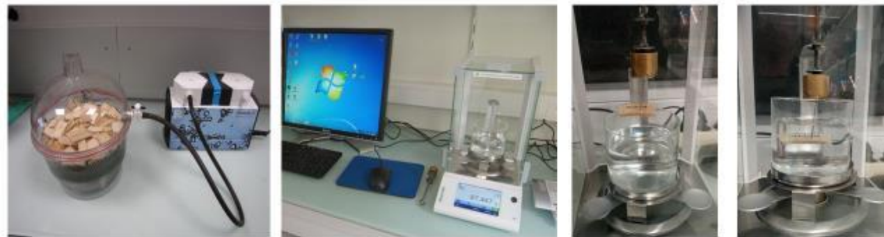
Saturation des échantillons dans l'eau et sous vide
